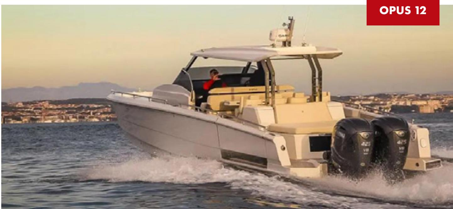
**Opus 12, luksuzni tender za mega jahte domaćeg proizvođača Opus Boats, imat će sajamsku premijeru na ovogodišnjem Biograd Boat Showu. Opus 12 je dug 12,3 m, širok 3,5 m te teži oko šest tona, a pokreće ga dva vanbrodska motora Yamaha V8s od 425 KS. Maksimalna brzina mu je 53 čvorova, dok pri brzini od 40 čvorova troši samo tri litre goriva, tako da nijedno odredište nije predaleko. Ova kombinacija pruža vrhunske performanse, brzinu i rukovanje.**
